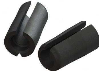
**2100/50N:** inserto serracavo da inserire in alloggiamenti diametro 8,25 mm per cavi con diametro tra 4,8 e 5,2 mm.
