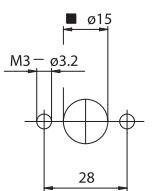
■ Foro per il passaggio del corpo in porcellana in fase di inserimento lampada
