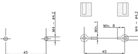
• Fissaggio del sezionatore utilizzando i fori di diametro 4,2 mm interasse 45 mm.
