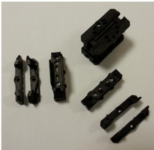
**M26UT1:** sezionatore modulare a 1 polo per la sola terra (Parte femmina 1 polo di terra IN + 1 polo di terra Out - Parte maschio 2 poli di terra OUT) con corpo in PA66 e temperatura di funzionamento T120°C.
