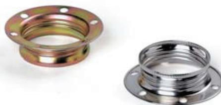
**476ZB:** ghiera di ferro zincato bianco con filettatura tonda 28 x2 mm alta 11 mm con flangia diametro 42,5 mm.
