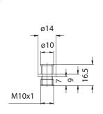
**1164/-:** Adattatore "cilindrico" in ottone grezzo per vetri con foro diametro 11 mm, battuta diametro 14 mm, e foro filettato "F" (vedere tabella sotto), per portalampada P44C e P44CY.
