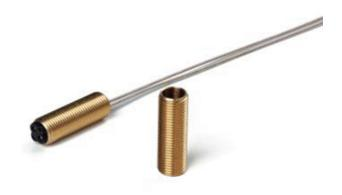
1149: Tubetto in ottone grezzo filettato M10 x1 alto 30 mm con foro interno per l'alloggiamento del portalampada P44C e P44CY.
