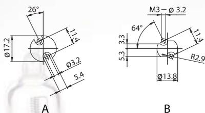
A - Fissaggio anteriore B - Fissaggio posteriore
