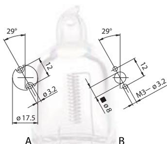
A - Fissaggio anteriore B - Fissaggio posteriore
